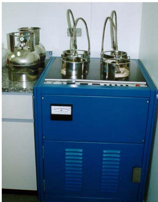
**Figura 32 - Sistema de lavagem de canister da Xontech.**
