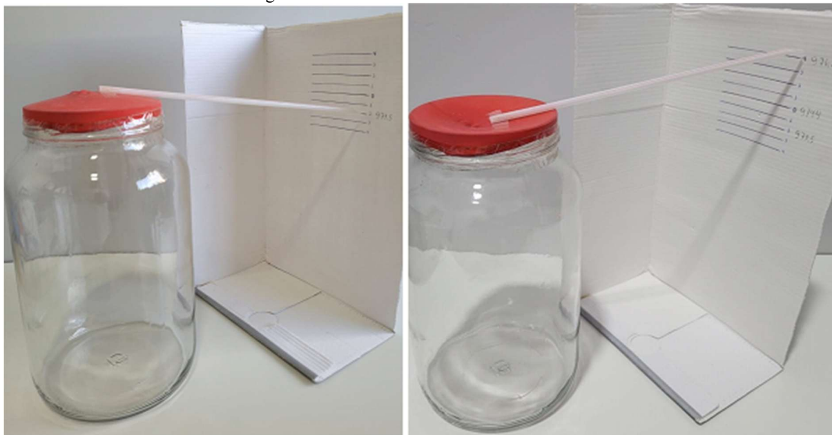
Figura 37 - Barômetro caseiro sendo calibrado
