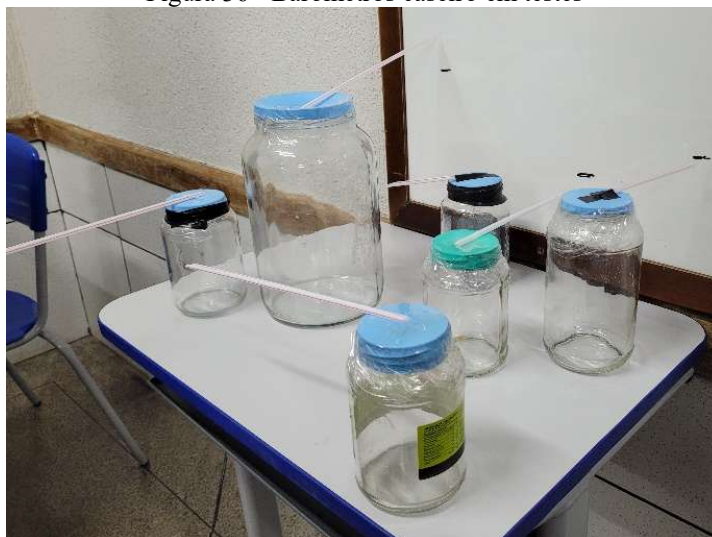
Figura 36 - Barômetros caseiro em testes
