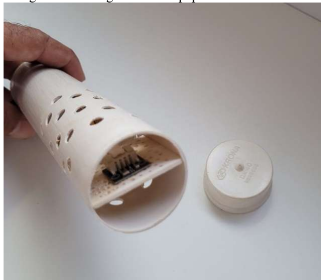
Figura 10 - Abrigo de PVC equipado com os Sensores
