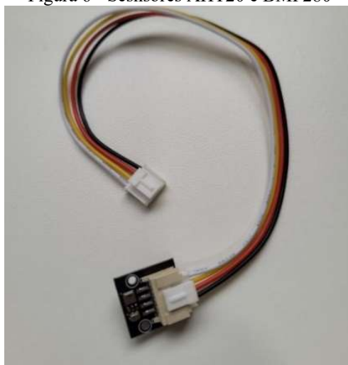
Figura 6 - Sensores AHT20 e BMP280
