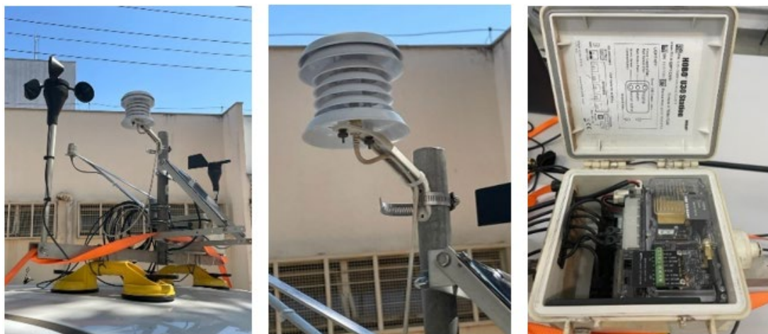
FIGURA 33 - Ilustração da montagem e fixação dos componentes da estação. Da esquerda para a direita, tem-se respectivamente: Estação montada e fixada no teto do veículo com ventosas e fitas de amarração; sensor de temperatura e umidade dentro do abrigo e Datalogger (Registrador de dados), abrigado em caixa e fixado sobre o veículo
