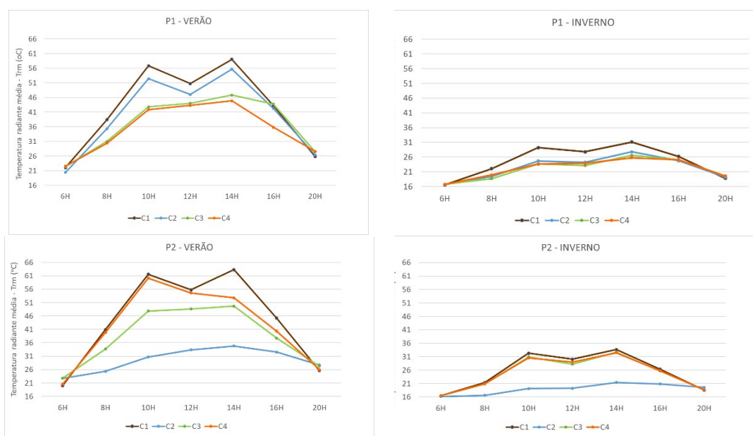
FIGURA 61 - Temperatura radiante média (oC), do Ponto A, nos cenários (C1, C2, C3, C4), no P1 (superior) e no P2 (inferior).
