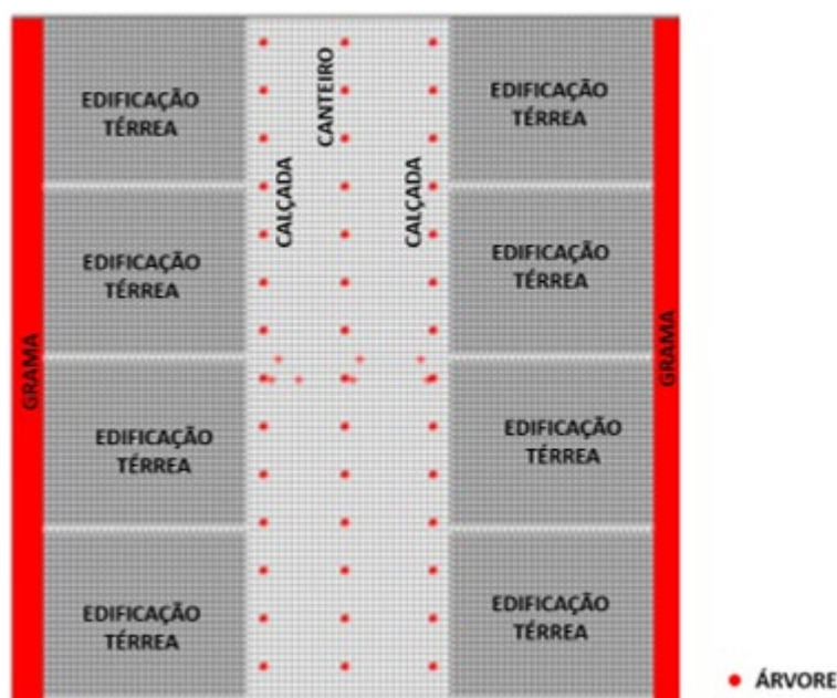
FIGURA 50 - Modelo geométrico para simulação paramétrica da análise do impacto do porte das árvores
