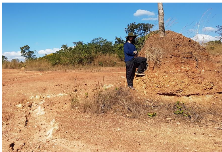
Figura 13 - Vista de região com concreções lateríticas do tipo petroplintita.
