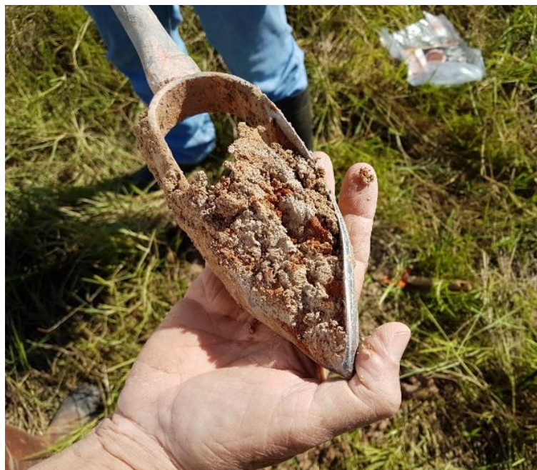
Figura 14 - Amostra de solo do tipo Plintossolo Argilúvico, com destaque para os nódulos ferruginosos de cor vermelho.
