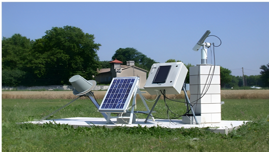
Figura 3.2 – Arranjo geral de medições da AERONET, incluindo o radiômetro solar, antena de transmissão de dados, painel solar, entre outros
