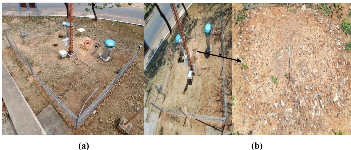
Figura 11. (a) Local da perfuração para instalação da sonda de temperatura multiponto; (b) Sonda instalada no ponto de medição.
