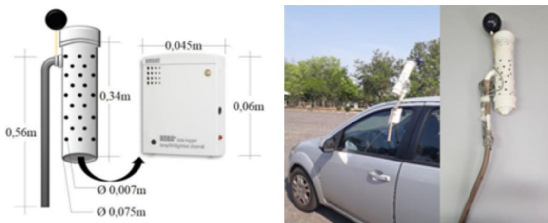
Figura 55 - Adaptação do sensor para transecto móvel, esquema representativo do abrigo alternativo PVC e sensor termo-higrômetro
