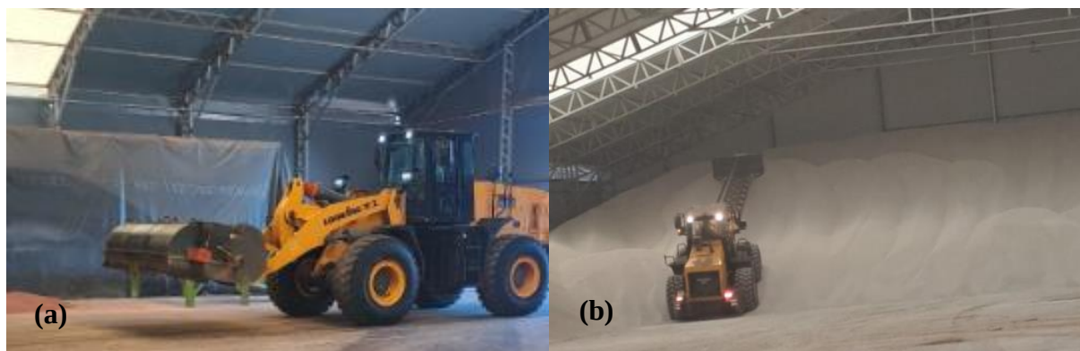
Figura 2 - A Pá carregadeira acoplada a uma vassoura mecânica (a) e pá carregadeira disposta de um remontador de 11 metros de comprimento para otimizar o espaço do armazém aumentando a altura do depósito (b).
