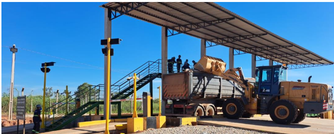
Figura 4 - Operador de pátio, em uma operação típica denominada “acerto de peso” feito pelo operador de balança rodoviária.
