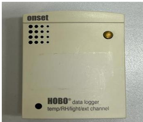
FIGURA 19: Sensor datalogger - Modelo Hobo FONTE: PRÓPRIA
