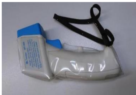
FIGURA 18: Termômetro digital infravermelho com mira laser (modelo MT-360)
