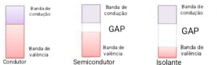
Figura 2.8: Banda de valência, band gap (GAP) e banda de condução: isolante, condutor e semicondutor. Fonte: (SAMPAIO; GONZÁLEZ, 2017), Adaptado.
