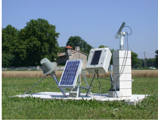
Figura 3.2: radiômetro espectral CE318 (Cimel Electronique, França) da rede AERONET. Fonte: AERONET NASA, disponível em: https://aeronet.gsfc.nasa.gov/ . Acesso em 13 de outubro de 2022.
