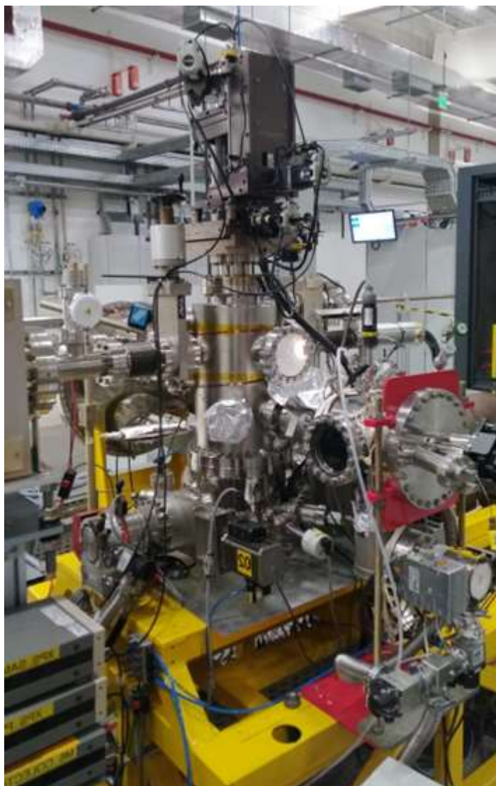
FIGURA 21 – Estação experimental XPS em atividade na Linha de Luz IPÊ/CNPEM
