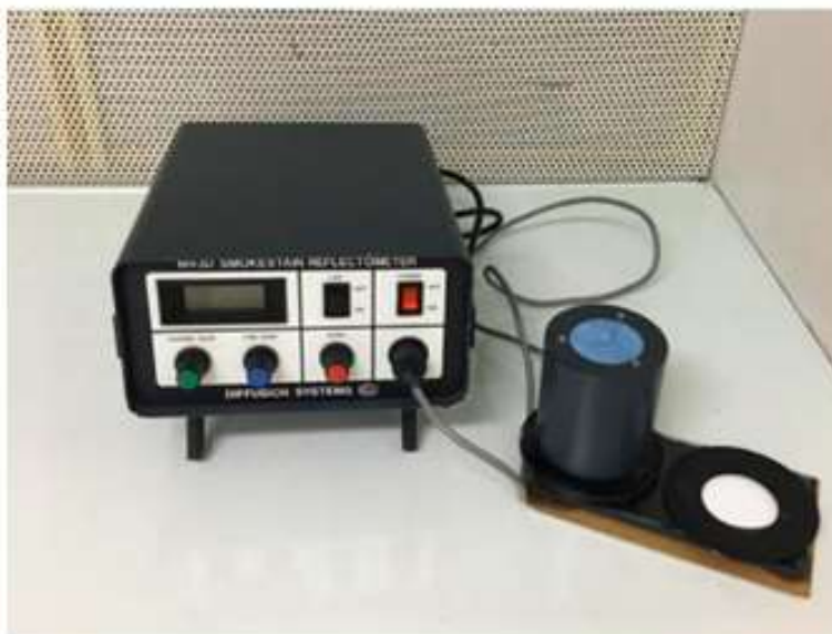
FIGURA 18 – Aparelho utilizado de Refletância Óptica em operação no LFA/ IFUSP FONTE: MORAIS; LANDULFO, 2022
