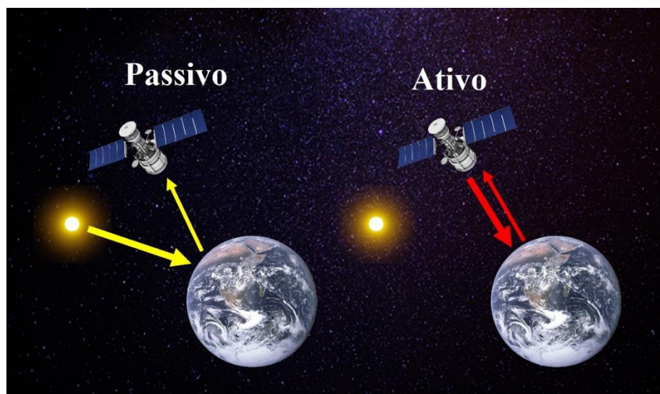
FIGURA 3 - Ilustração dos conceitos de sensor ativo e sensor passivo
