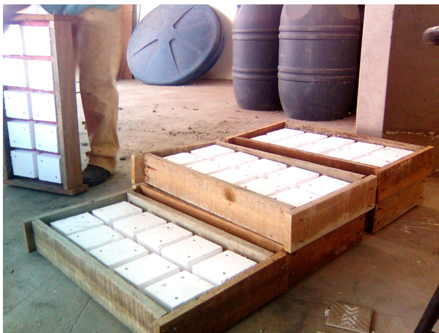
FIGURA 23 – Fôrmas de molde para a execução das placas de concreto
