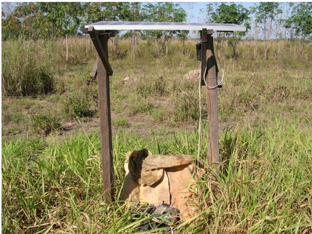
Figura 6 – Sistema de alimentação dos sensores e “dataloggers”.
