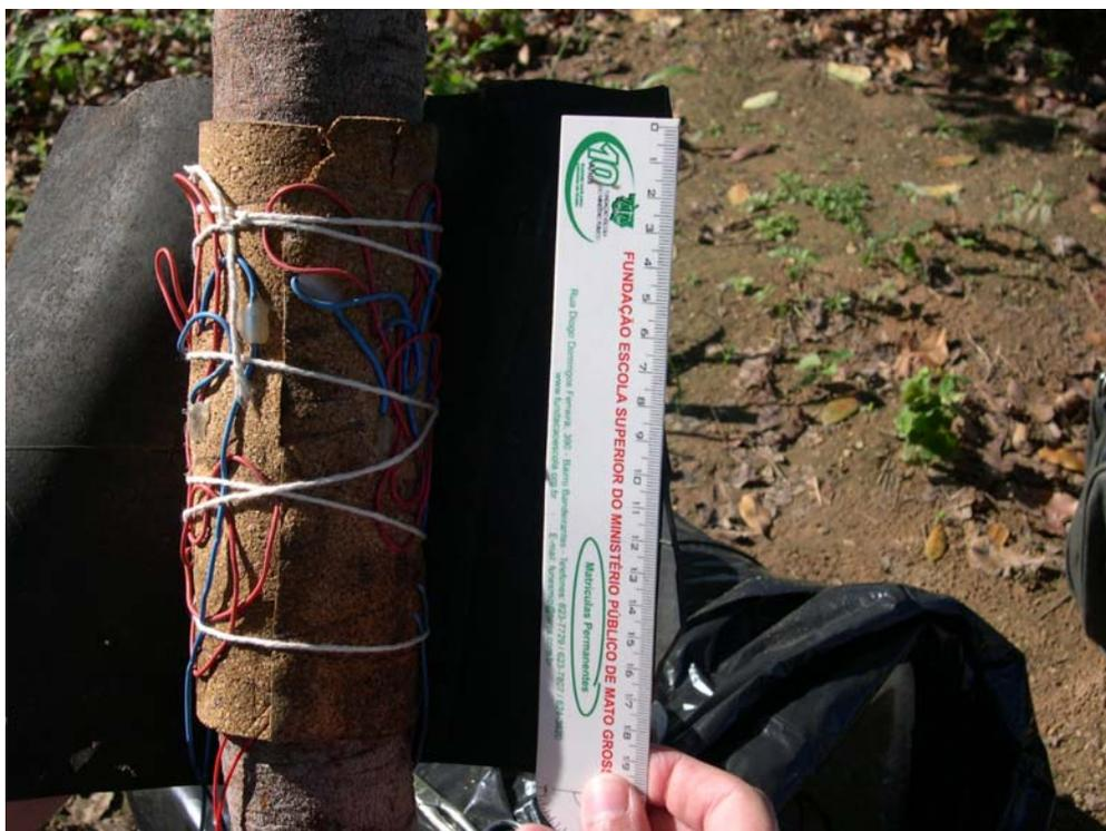
Figura 3 – Detalhe do isolamento com borracha.
