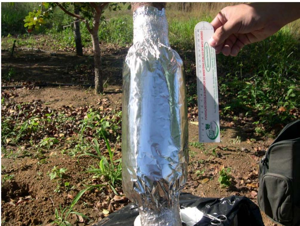
Figura 5 – Detalhe do isolamento com lâminas de papel alumínio.
