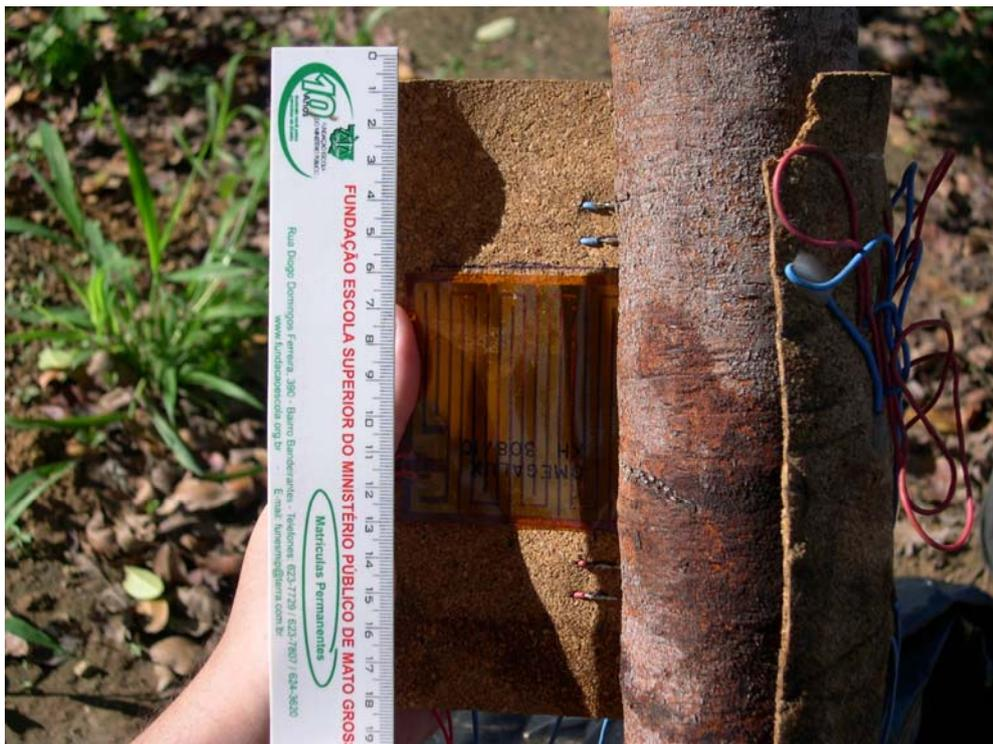
Figura 2 – Detalhe da fixação da termopilha e termopares (jaqueta térmica).
