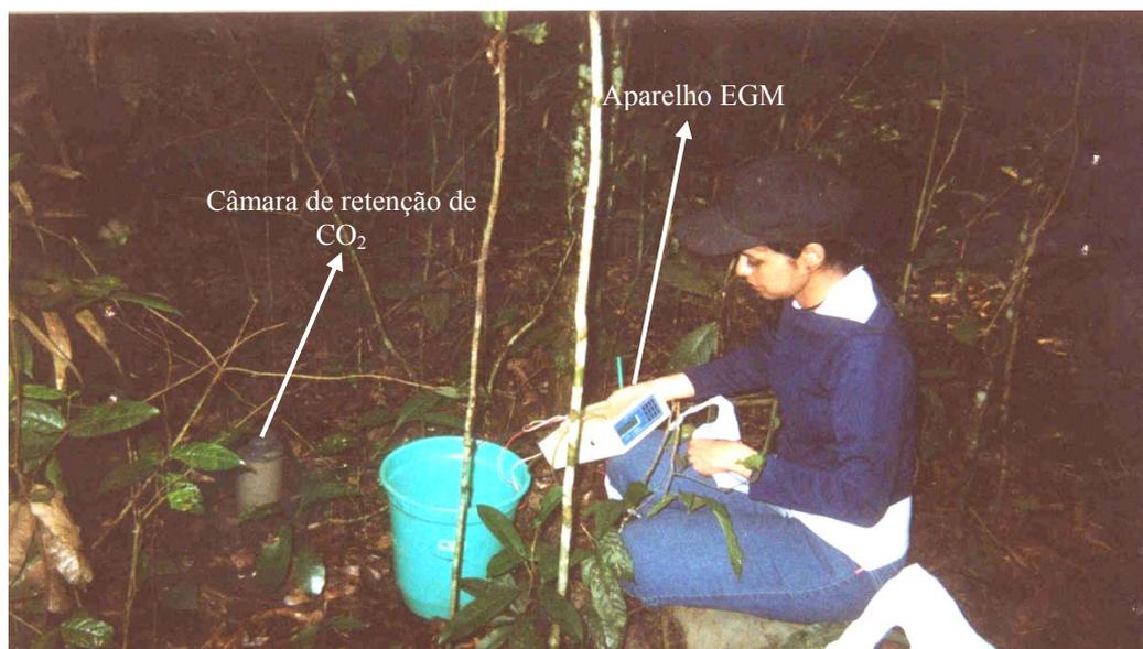
**Figura 3** - Medidas do Efluxo de  $\text{CO}_2$  no solo, utilizando o aparelho EGM.
