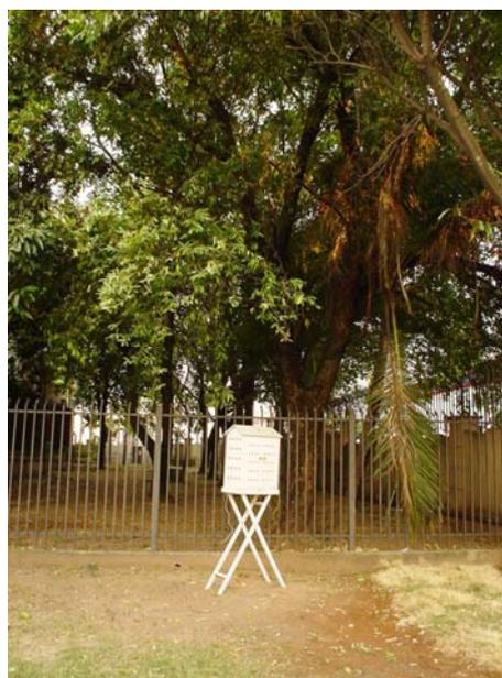
**FIGURA 9** - Instalação do Abrigo Termométrico à Sombra.
