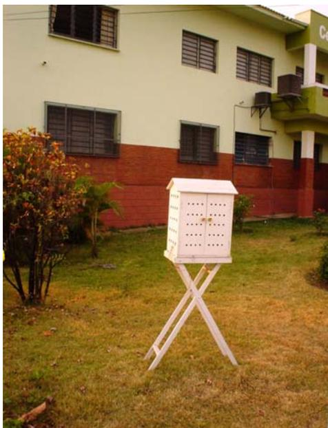
**FIGURA 8** - Instalação do Abrigo Termométrico ao Sol.
