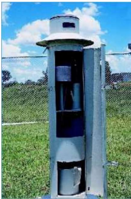
**Figura 4: Pluviógrafo.**
