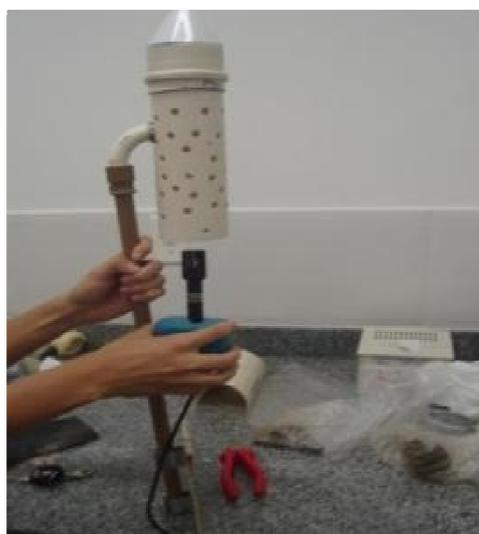
**Figura 8** – Abrigo com o sensor do termo-higrômetro-anemômetro instalado e apto à coletas.
