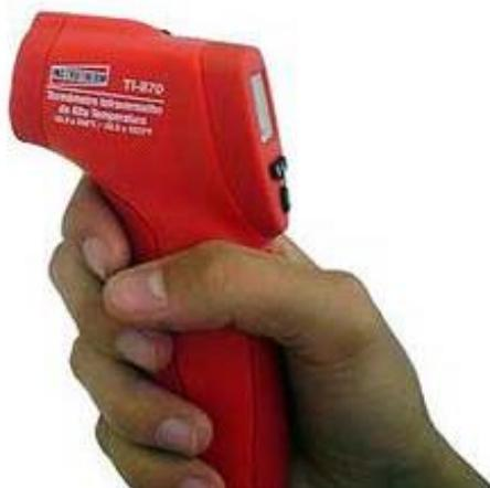
**Figura 6** – Termômetro infravermelho Instrutherm, modelo TI-870.
