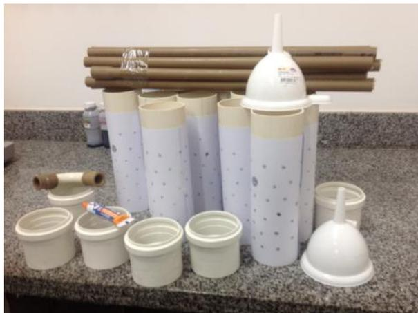
**Figura 7** – Insumos empregados na fabricação do abrigo pelo laboratório de instrumentação do PPFGA.
