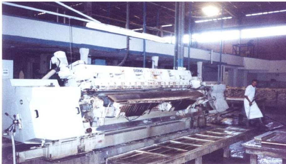
Figura 5: Processo de divisão da pele em duas camadas.
