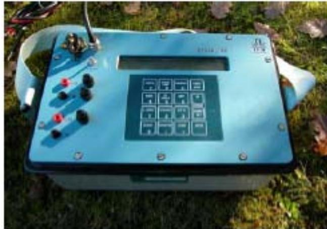
Figura 35. Equipamento de Eletrorresistividade Syscal R-2
