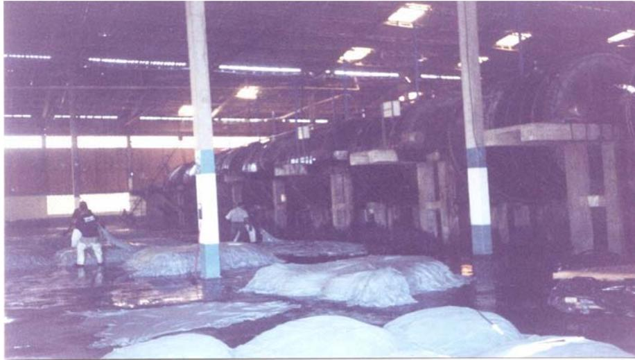
Figura 6: Retirada do resíduo líquido em excesso das peles.
