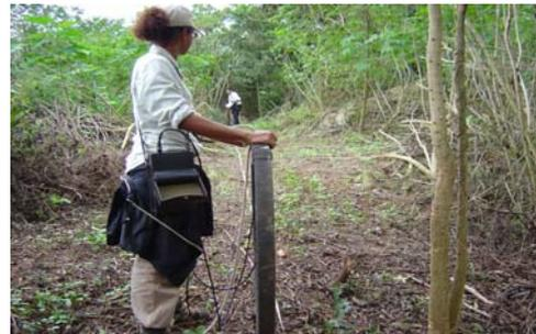
Figura 33 Trabalhos de campo em que se observa o emprego do método eletromagnético indutivo.
