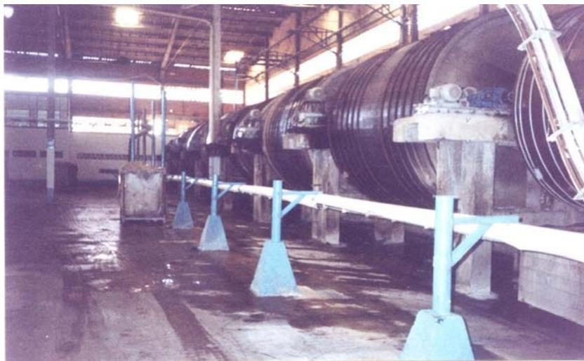
Figura 2: Processo de depilação e caleiro dentro dos “fulões”.
