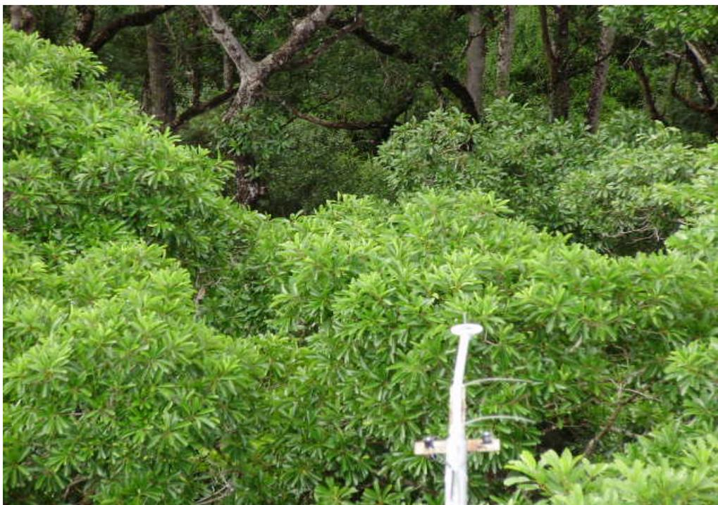
**Figura 4** - Saldo radiômetro instalado no Cambarazal
