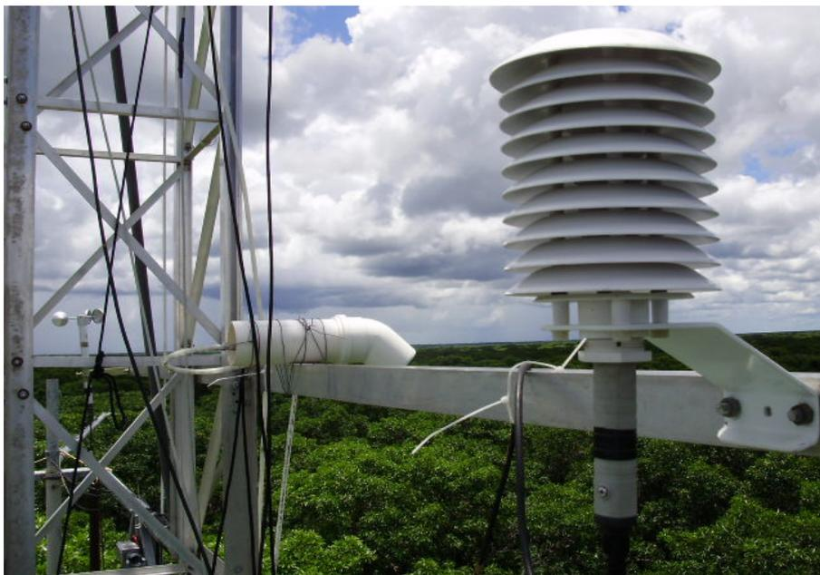
**Figura 6** - Termohigrômetro instalado em seu suporte
