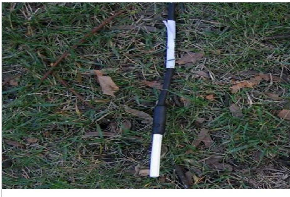
**Figura 7** - Termistor utilizado para medir a temperatura do solo no Cambarazal
