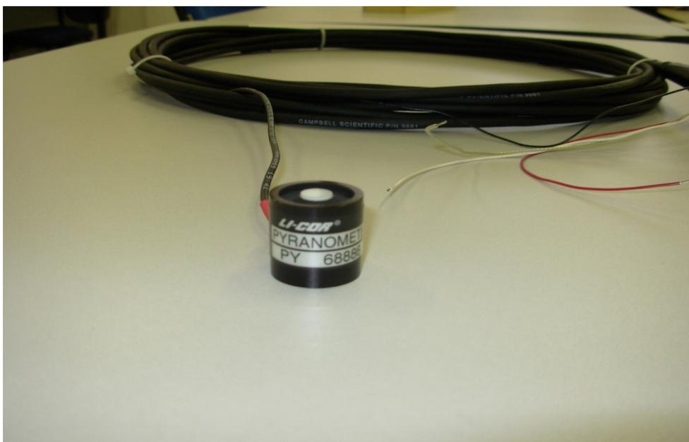
**Figura 5** - Piranômetro (LI - 200) utilizado para medir a radiação global
