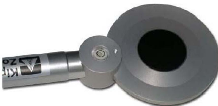
**Figura 3** - Equipamento (Saldo radiômetro) usado para medir o saldo de radiação
