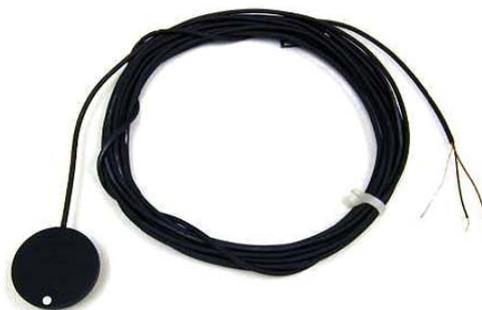
**Figura 10-** Placa de fluxo de calor no solo.
