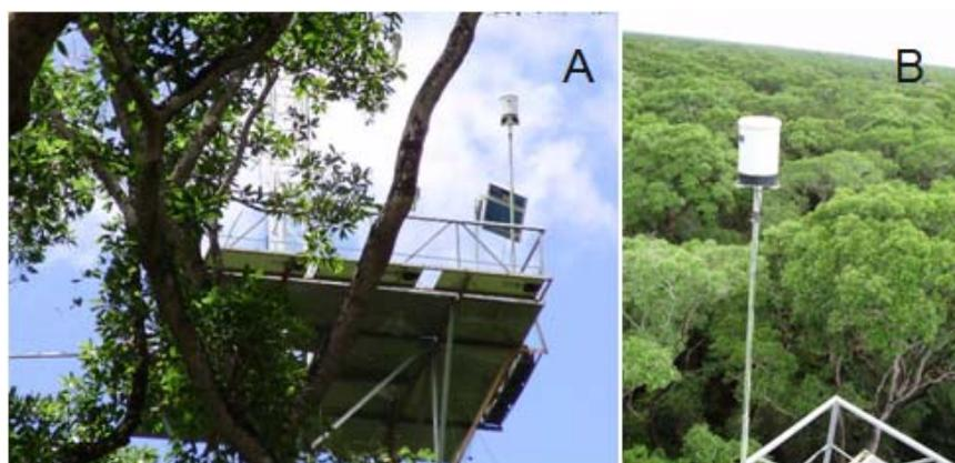
**Figura 9-** Pluviômetro de balança visto de baixo da torre (A) e (B) visto de cima da torre.
