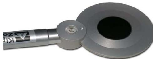
**Figura 5-** Net Radiômetro.
