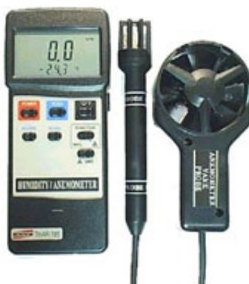
**FIGURA 15** Termo-higro-anemômetro utilizado
