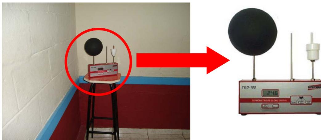
**Figura 21** - Termômetro de Globo Digital da marca Instrutherm e seu suporte
