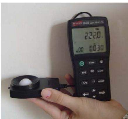
**Figura 24** - Luxímetro Digital Portátil
