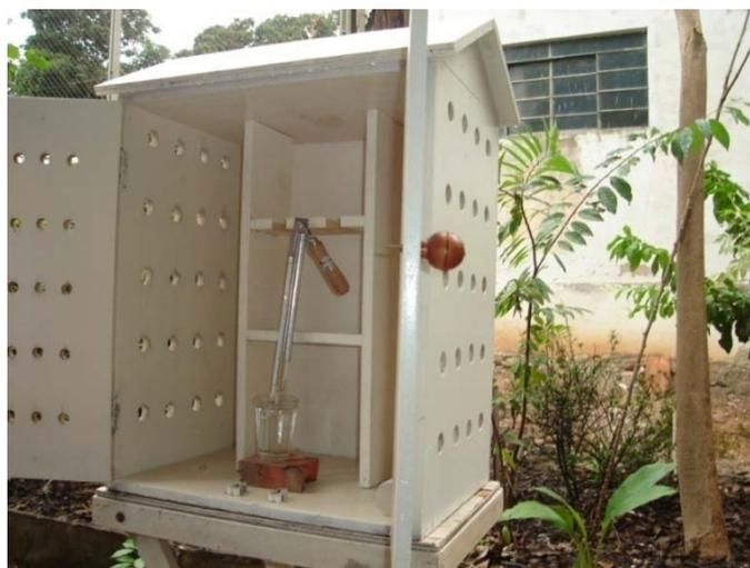
**Figura 23** - Psicrômetro instalado no abrigo meteorológico localizado externamente (PE) no quintal ecológico
