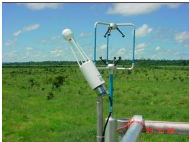
Figura 8: Anemômetro sônico e analisador de gases
