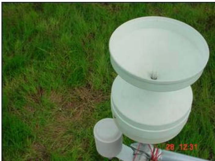
Figura 7: Pluviômetro e psicrômetro
