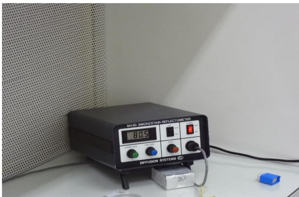
**Figura 12.** Refletômetro usado para a quantificação do BC (SANTOS, 2014).
