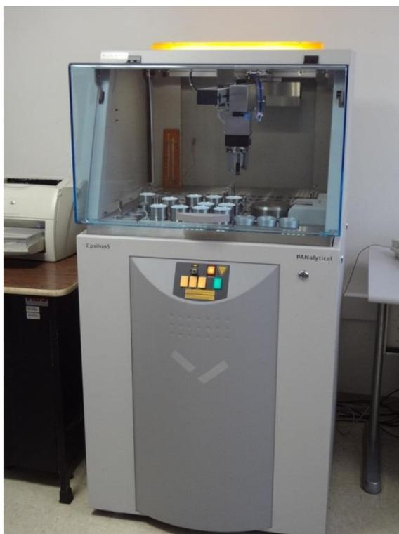
**Figura 13.** Aparelho utilizado para quantificação elementar das amostras utilizando indução por Raios-X (SANTOS, 2014).
