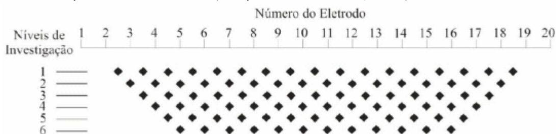
**FIGURA 30** - Distribuição de pontos investigados em uma pseudo-seção através do arranjo dipolo-dipolo (BORGES, 2004)
