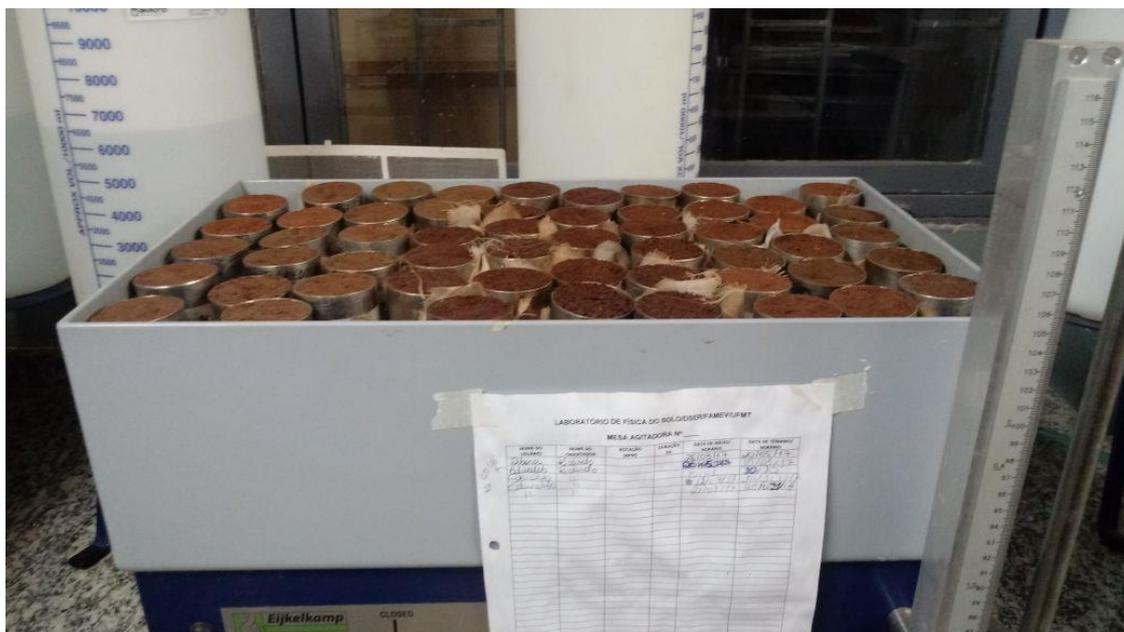
**Figura 8** - Mesa de tensão do laboratório de solos do Programa de Pós Graduação em Agricultura Tropical (PPGAT – UFMT).
