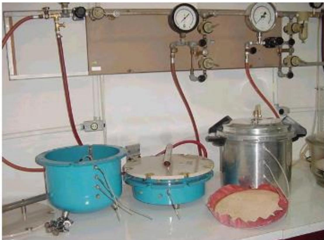
**Figura 9** – Imagem de um modelo meramente representativo da Câmara de Richards.
