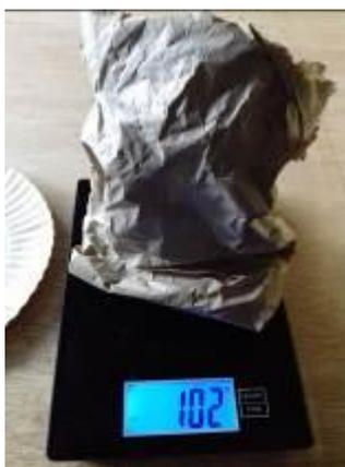
**Figura 25.** Amostra de terra sendo pesada após secagem.
